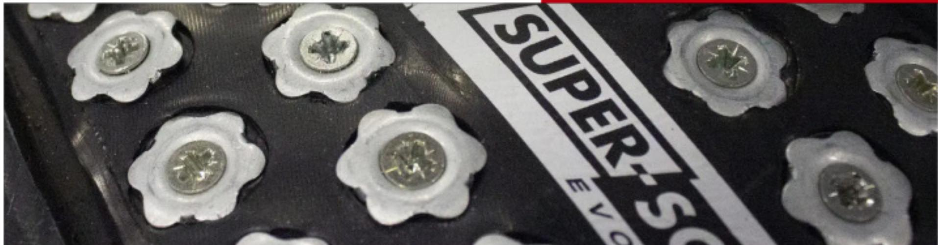
سوپراسکرو یا بلت کوپلینگ (Belt Coupling) Super Screw ترکیبی از الیاف پلی استر، قطعات فولاد، لاستیک و پیچ های خودکار فولادی است و جهت اتصال دو سر تسمه نقاله برای راه اندازی مجدد سیستم به کار می رود، این محصول ساخت کمپانی MLT فرانسه است.
